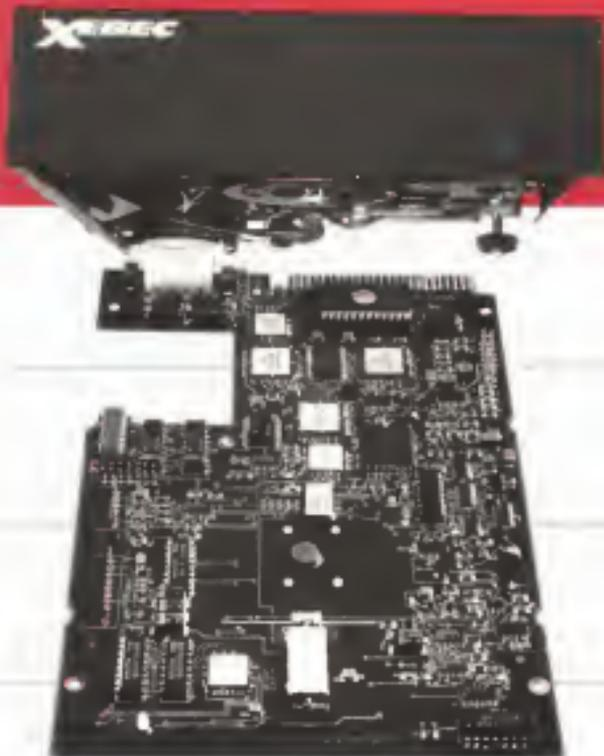
La XEBEC, il più grande costruttore di controller per Disk Drive e di memoria di massa a disco per i sistemi a microprocessori, merita la sua plurennale esperienza accoppiata con dischi duri e controller nell'"OWL" che integra un disco "SLIM" Winchester ed un controller SASI in un unico dispositivo.
